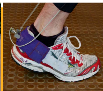
測試圖片：試用者繫上科學儀器，檢測腳部和跑步鞋之間的生物力學數據。
