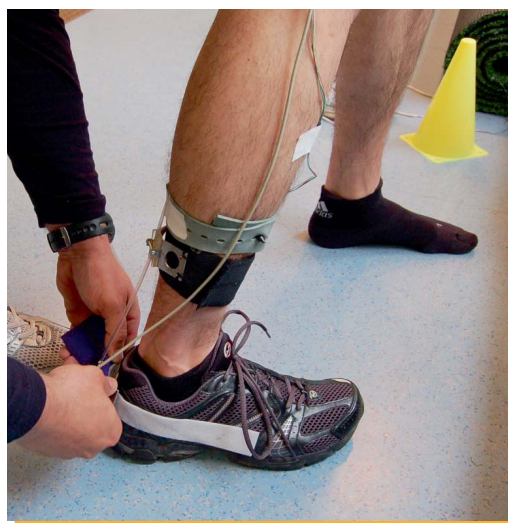
測試圖片：試用者繫上科學儀器，檢測腳部和跑步鞋之間的生物力學數據。
