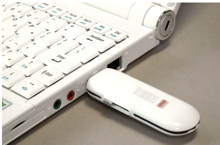
外置3G數據機佔用USB插座，但可隨時插在不同的電腦上使用。
