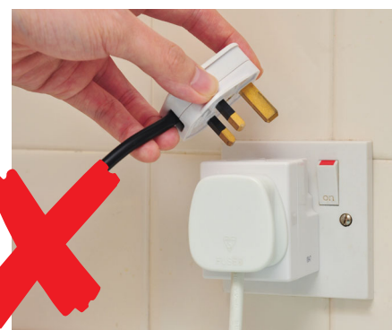
電磁爐輸入電流頗大，不應與其他電器共用同一插座。
