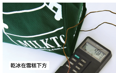
移動乾冰的位置，可以令包裝袋底的溫度有很大變化。
