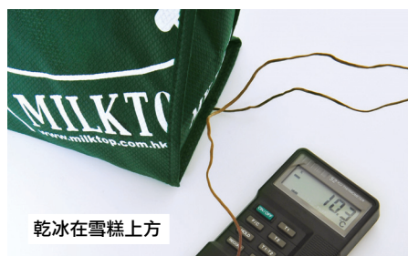
移動乾冰的位置，可以令包裝袋底的溫度有很大變化。
