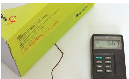
包裝盒底的溫度可低至零下五十多度。
