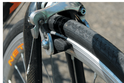
V形煞車系統的制鉗靠近車輪外圈，有機會沾上泥土，影響煞車。
