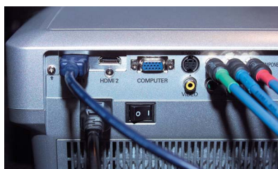
▲ 備有VGA接頭的樣本可顯示電腦畫面。 ◀ 以HDMI輸入接線很方便，一條線集齊訊息。
