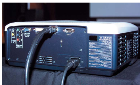
▲ 備有VGA接頭的樣本可顯示電腦畫面。 ◀ 以HDMI輸入接線很方便，一條線集齊訊息。
