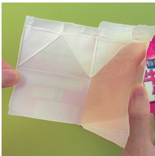
經超高溫殺菌法處理的牛奶(左)，包裝物料須阻隔光線，例如紙盒內層是不透光的鋁箔。相反，經巴士德消毒的牛奶(右)，包裝紙盒無阻光物料，在燈光下可見透光的情況。
