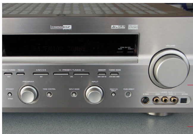
大型影音接收器 (AV receiver) 面板較大，不少有音頻 / 視頻輸入端方便接駁可攜式器材。
