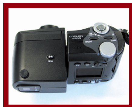
「尼康」Coolpix 4500設有可旋轉鏡頭，方便高低角度拍攝
