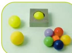
小球試驗：球體可穿過圖中測試裝置會界定為小球，潛在窒息危險
