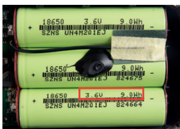
樣本「PRODA」(#19)標示的電容量/電能為10,000mAh/37Wh(上圖)，但其電池標示的電壓及電能則為3.6V及9Wh(總和27Wh)(下圖)。
