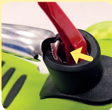
部分樣本的手柄管於強度測試後斷裂或移位。
