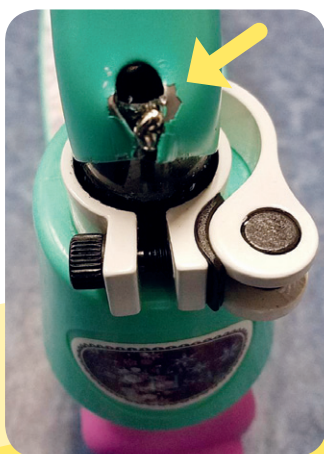
部分樣本的手柄管於強度測試後斷裂或移位。
