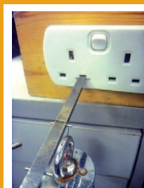
標準要求插孔須把「試驗插腳」持續夾穩30秒或以上。
