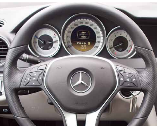
軟盤上的按鈕方便駕駛時雙手毋須離開軟盤便可調校不同功能。
