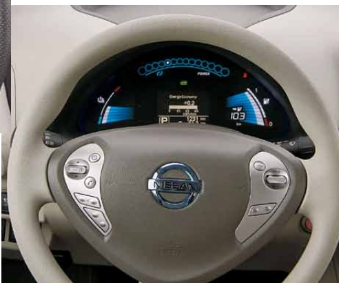
軟盤上的按鈕方便駕駛時雙手毋須離開軟盤便可調校不同功能。
