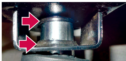
▲座椅的組件跟氣壓棒接觸的位置分為兩部分（即箭咀所指位置）而非一個整體，使用時可能令氣壓棒受力不均，日久使用下可能令氣壓棒變形及破壞氣壓棒的結構。
