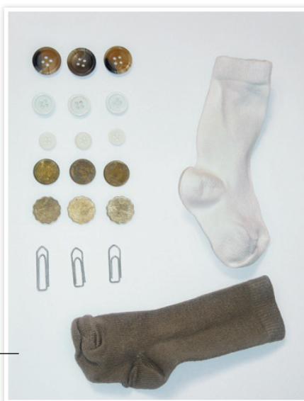
把圖中的小物件放入洗衣機滾筒內，測試洗衣後遺留在機內的情況。
