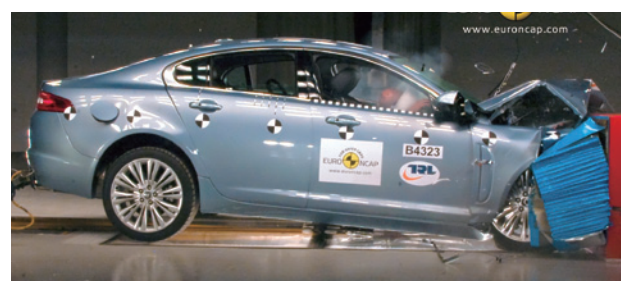
行政人員房車「積架 Jaguar」XF (#6) 樣本的儀表板等結構在撞擊時可能會令司機及前座乘客受傷。
