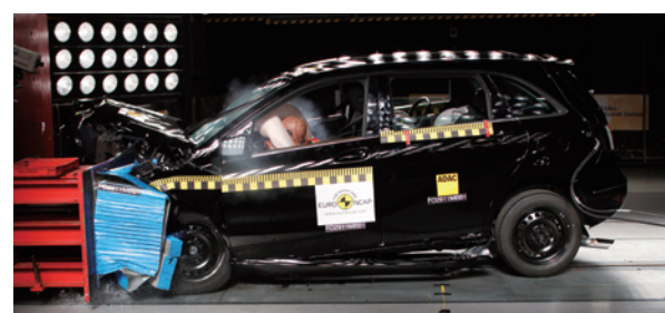
行政人員房車「積架 Jaguar」XF (#6) 樣本的儀表板等結構在撞擊時可能會令司機及前座乘客受傷。
