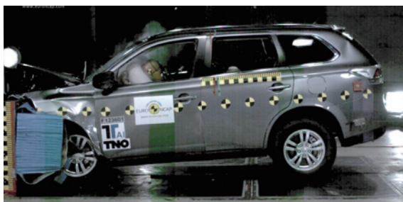
小型越野車「三菱 Mitsubishi」Outlander (#17) 樣本在正面撞擊測試中，司機及前座乘客都得到良好保護。
