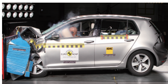
小型家庭房車「Volkswagen」Golf (第七代) (#12) 樣本在正面撞擊測試中對前座乘客的保護獲得滿分。
