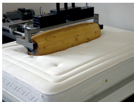
▲耐用程度測試，用約重140公斤的滾筒來回壓床褥30,000次。
