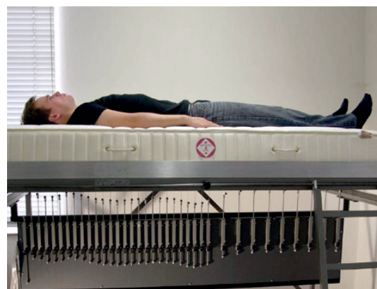
▲仰臥時量度身體不同部位令床褥下陷的幅度，計算床褥承托身體的表現。
