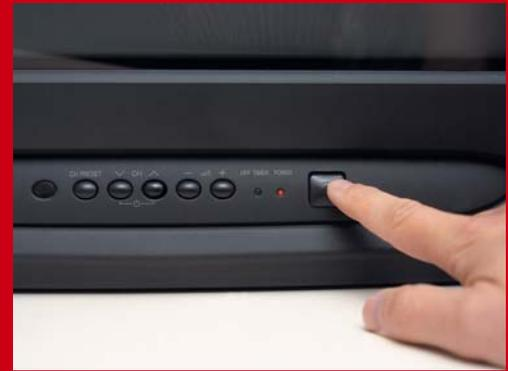
用遙控器關機後，電源顯示燈依然亮着表示電視機在備用狀態，仍有電流通過一些元件。
