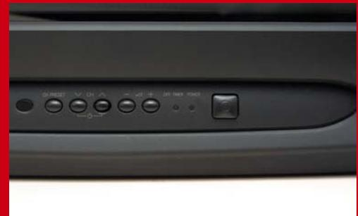
要完全切斷電源，可按電源開關按鈕(標誌為ⓐ)，顯示燈便徐徐熄滅，表示電源已經切斷。再按掣便可令電視機回復備用狀態，用遙控開機可繼續觀看電視。
