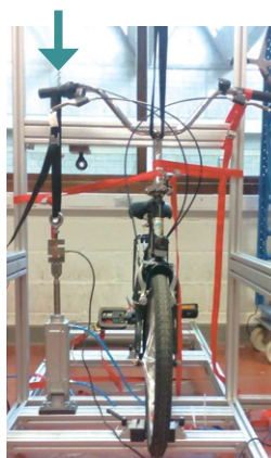
在實驗室內測試單車樣本把手的堅固度。
