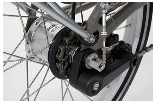
樣本 #1 的後輪飛輪設 2 齒輪，後輪花鼓 (hub) 內設 3 個內變速齒輪，可組合改變 6 個速度。
