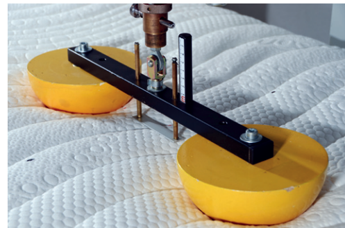
彈性測試，用兩個半球體模擬臀部及肩膀於樣本上施壓，然後量度床褥樣本在兩個半球體中間部分與原有水平的差異，從而評估樣本於兩點壓力下的彈性。
