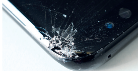
滾筒撞擊測試後，#1及#2的屏幕破裂。
