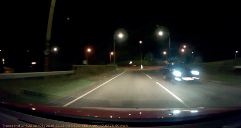
「Transcend」520 (#10) 晚間拍攝的影片中眩光情況嚴重，車頭燈的光線影響閱讀車牌號碼。
